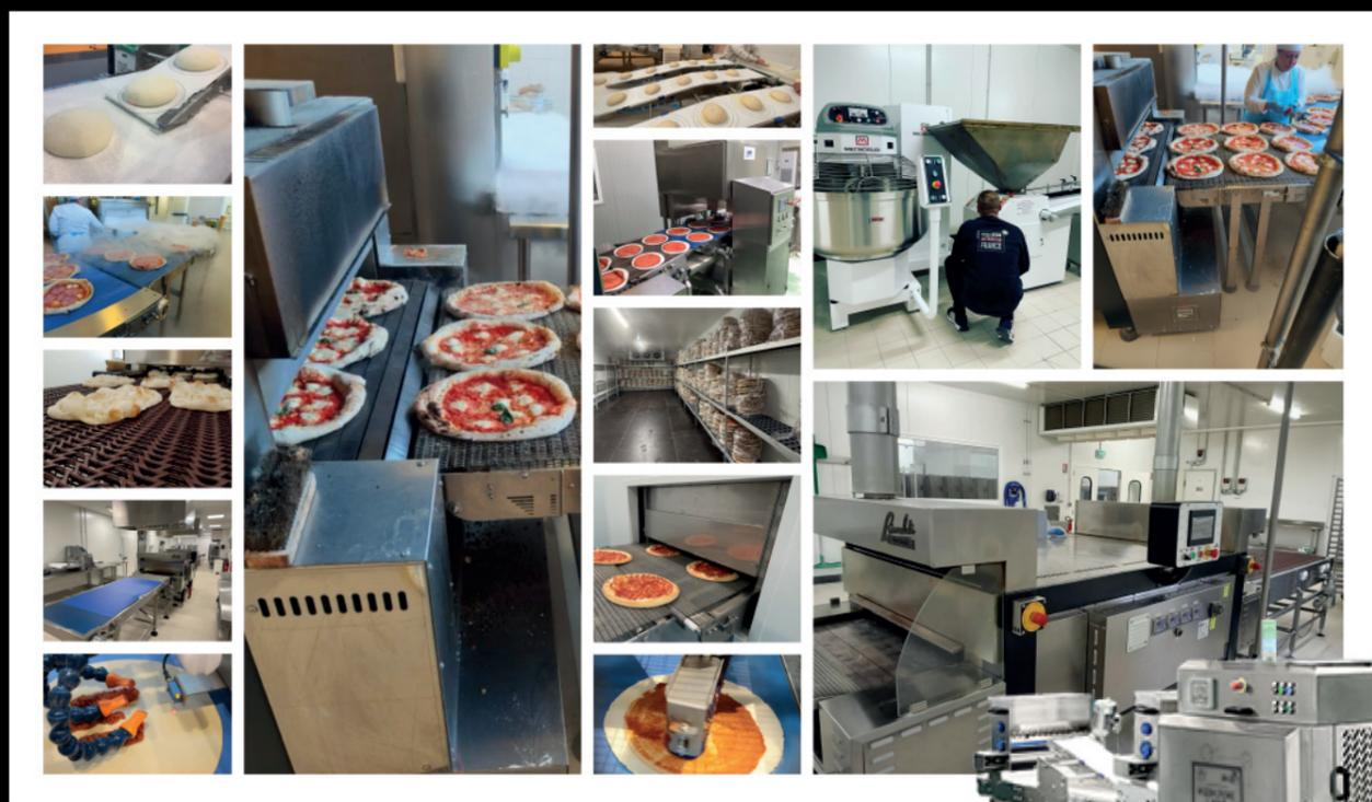
Pour la cuisson, nous proposons nos fours tunnels convoyeurs, ultra performants, de 1 à 15m de long, fours mixtes bois/gaz rotatifs, électriques rotatifs/statiques à grande capacité, vous permettant de cuire ou précuire en grande quantité vos fonds ou vos pizzas avec des capacités de 100 à 1000 unités par heures.
